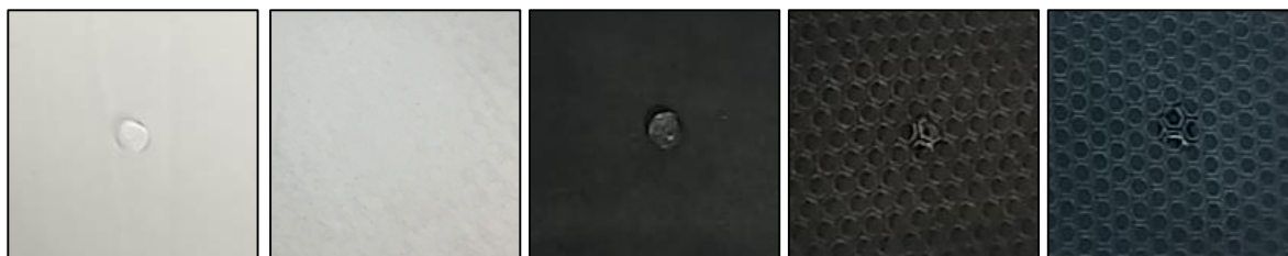
Figura 1 Immagine dei materiali subito dopo la bagnatura. Da sinistra a destra: TNT FS790, TNT FS790 + SQD, LN043, LN043T02 + SQD e LN043 con ricetta modificata.
